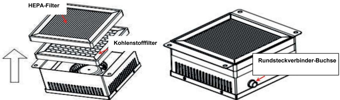
3. Positionieren Sie nach dem Filterwechsel den Luftreiniger und ziehen Sie die 4 Schrauben fest. Besondere Hinweise: Die Aviation-Buchsen des Luftreinigers müssen zur Rückseite des Ofens zeigen!
